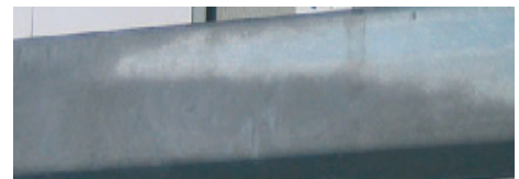
Färgskiftningar i ytan kan förekomma, men påverkar inte kvaliteten på korrosionsskyddet. Anledningen är att reaktionen mellan zink och järn går olika fort beroende på typ av stål samt svalningsförloppet efter förzinkningen.
