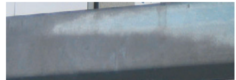
Pinnassa voi esiintyä sävymuutoksia, mutta se ei vaikuta korroosiosuojan laatuun. Syynä tähän on, että reaktio sinkin ja raudan välillä tapahtuu eri nopeuksilla riippuen terästyyppistä ja jäähtymisnopeudesta sinkityksen jälkeen.
