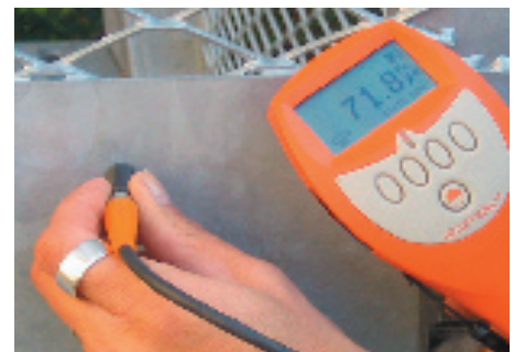
Sinkkikerroksen paksuuden mittaaminen.
